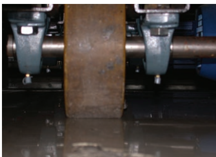
Afb. 6 Geconcentreerde belasting op een vloer.
